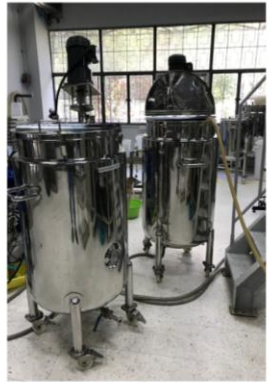
ミキシングタンク Mixing tank
